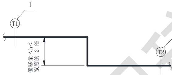
（b）风管和电缆桥架偏移做法示意图
