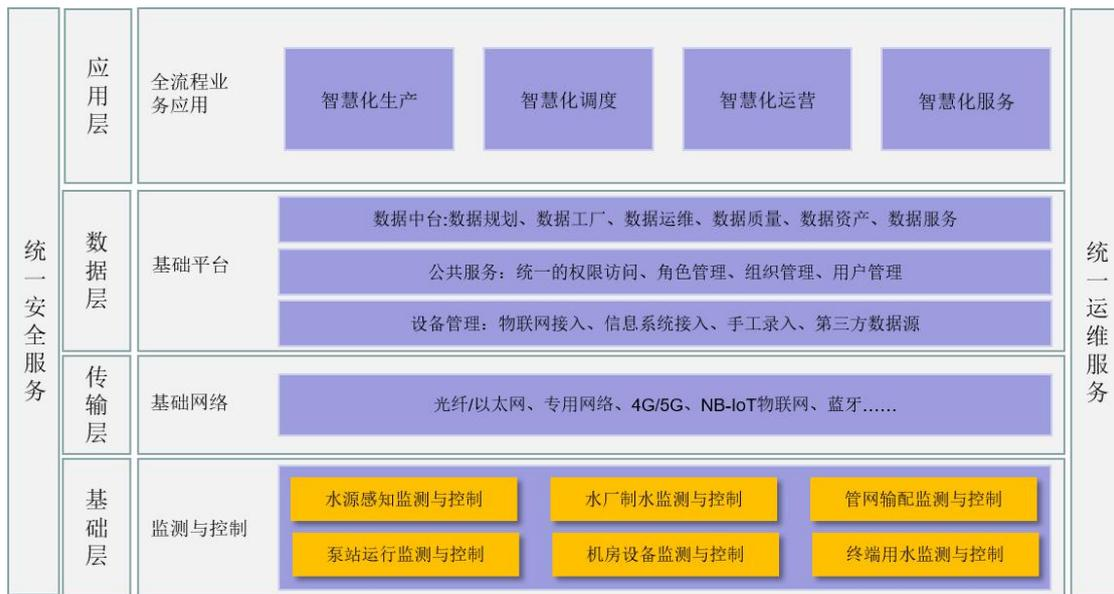
图 5.1 辽宁省城镇智慧供水信息化工程总体框架
