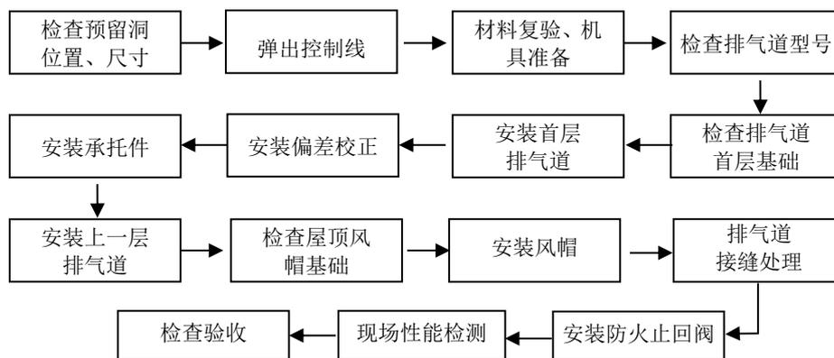
图 2 排气道系统施工工艺流程
