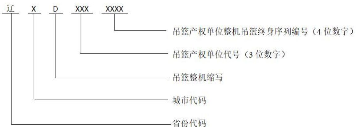
图 3.1.3-1 吊篮整机档案编号规则示例
