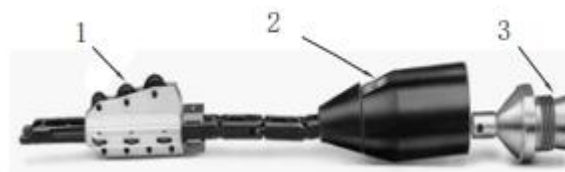
1—裂管刀具；2—胀管头；3—管道连接装置
